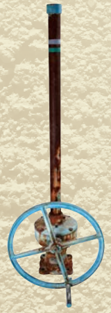
宮井用水 水門ハンドル（紀の川左岸土地改良区蔵）
